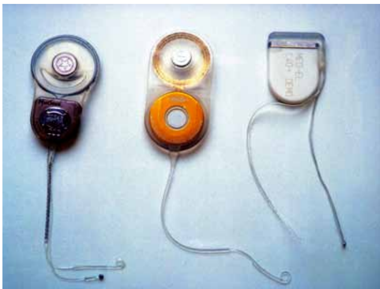
Drie voorbeelden van het inwendige deel van een cochleair implantaat. De ontvangspoel en de elektrode zijn afgebeeld.
