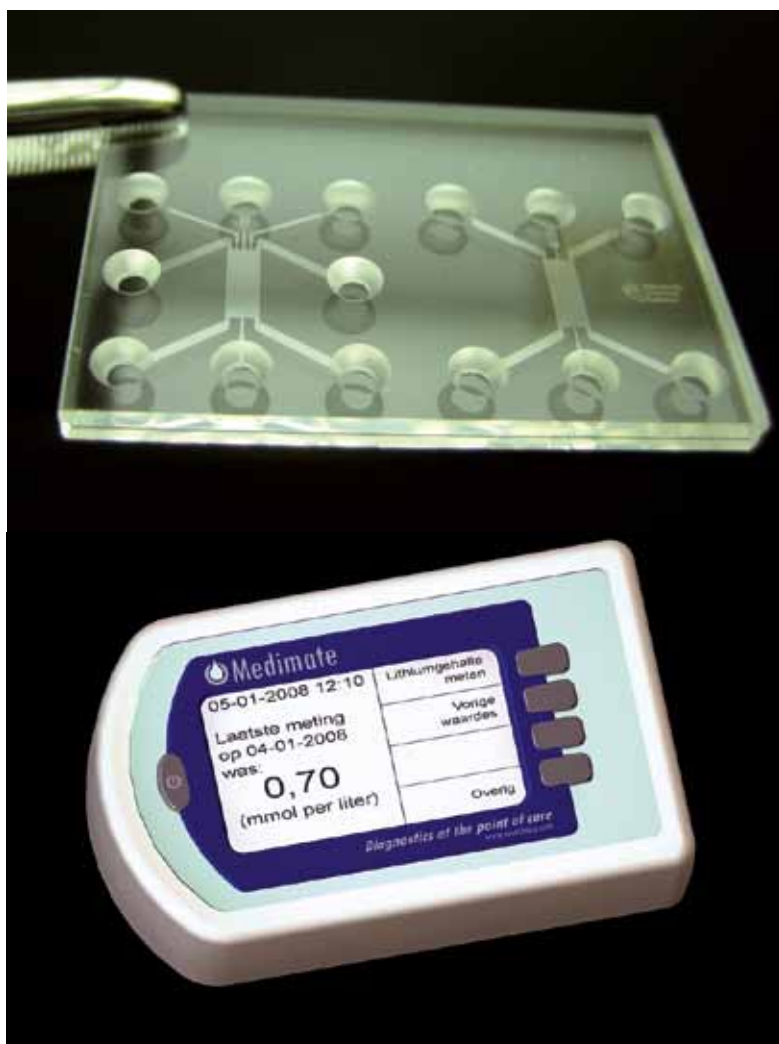
Een lab-on-a-chip (boven) en een Medimate Multireader voor het meten van lithiumwaardes.
